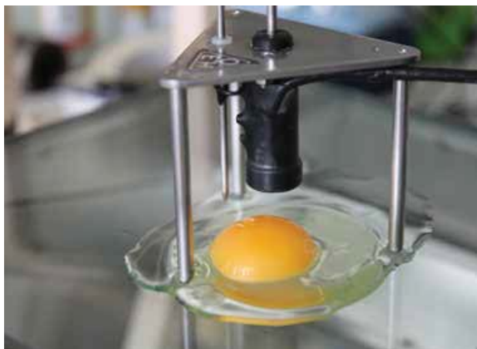
Ce dispositif mesure la hauteur du blanc pour connaître la fraîcheur de l'œuf.
