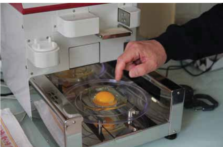
Poids, hauteur du jaune, diamètre du blanc, solidité de la coquille... : cette machine passe au crible les œufs.
